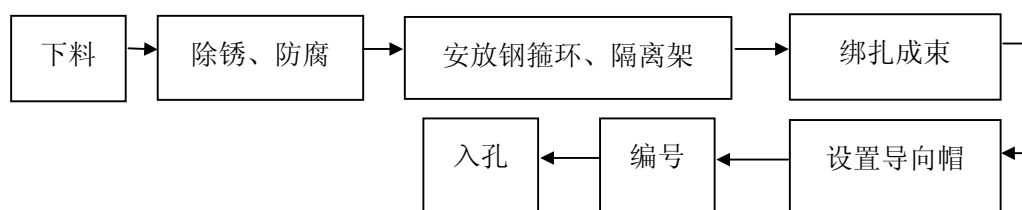
图 2-1-5-5 锚索制安流程图
