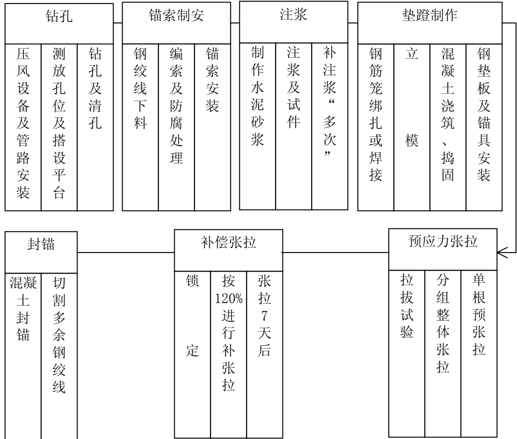
图 2-1-5-3 锚索施工工艺流程图
