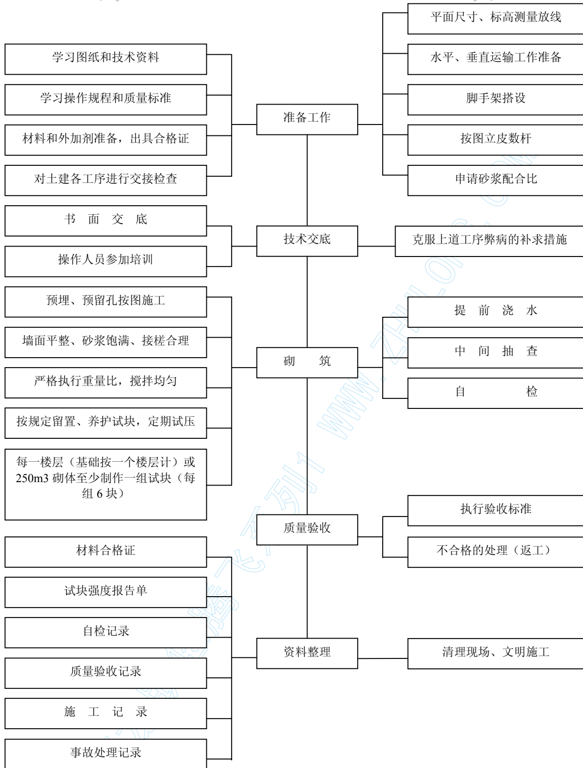
图 6-12 砌体工程质量控制程序
