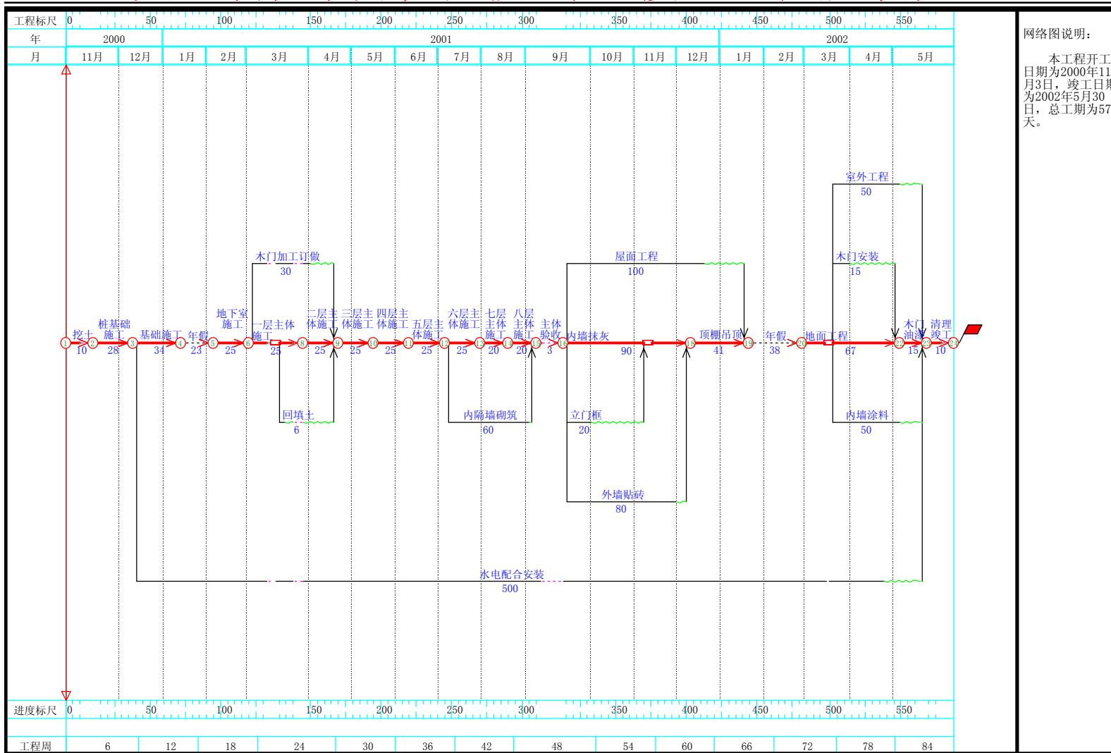
图 7-2 B 段工程进度网络图
