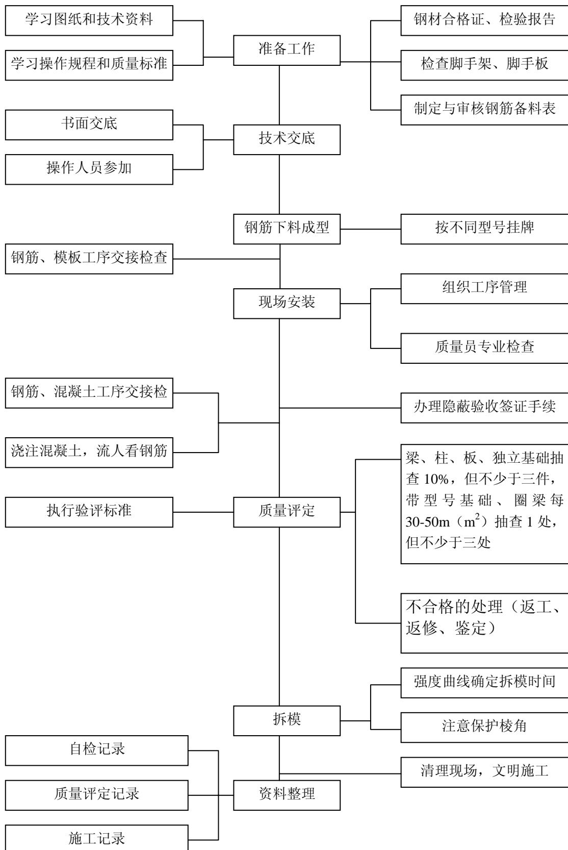
图 8-3 钢筋工程质量预控程序
