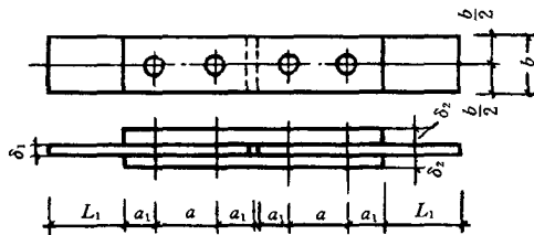
图 8.4.2 抗滑移系数试件
