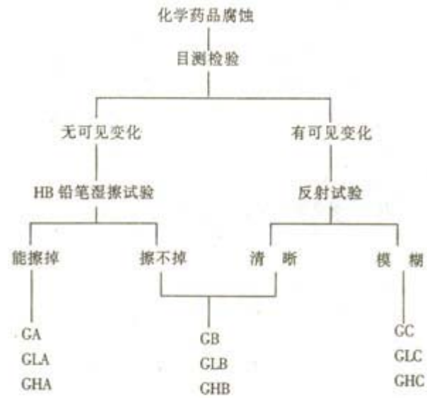
图1 有釉砖耐腐蚀级别划分表
