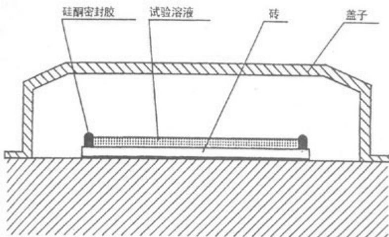
在试验期间,房间的温度应保持在 $(20 \pm 2)^\circ\text{C}$ ,并避免试验装置被太阳直接照射或接近其他热源。
