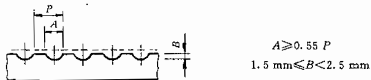
图 2 齿型尺寸
