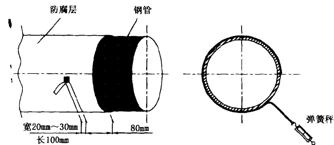
图 G.0.2 剥离强度测试示意图
