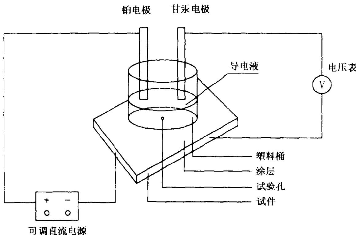
图 B.0.3 防腐层阴极剥离试验示意图
