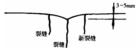
附图 3.1.3 唧浆造成裂缝处沉陷示意图
