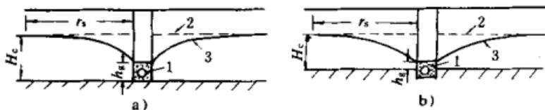
图 8.3.1 不透水层坡度平缓时的渗沟流量计算
