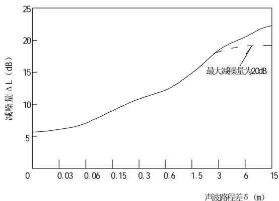
图E1-4  $\Delta L_2$ 声影区- $\delta$ 关系曲线
