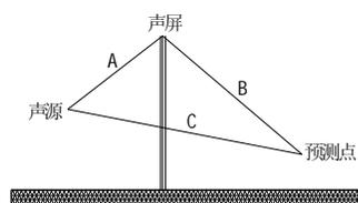
图E1-3 声程差计算示意图
