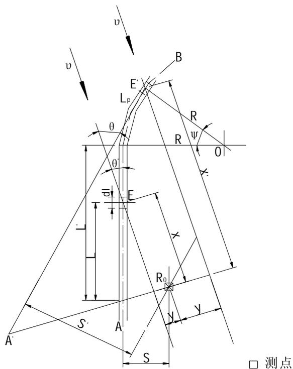
图注： $\theta$  或  $\theta'$  ——风速矢量与线源（公路中心线）夹角，简称风向角（ $^\circ$ ）；
