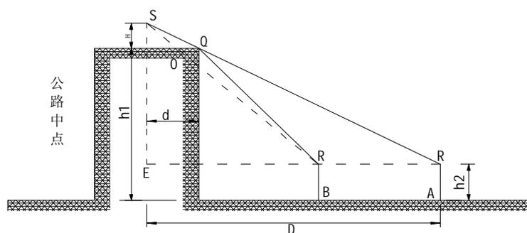
图 E 1-1 高路堤声照区及声影区示意图
