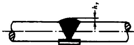
图 2 焊缝余高
