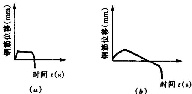
图 14 预埋件钢筋埋弧压力焊上钢筋位移图解
