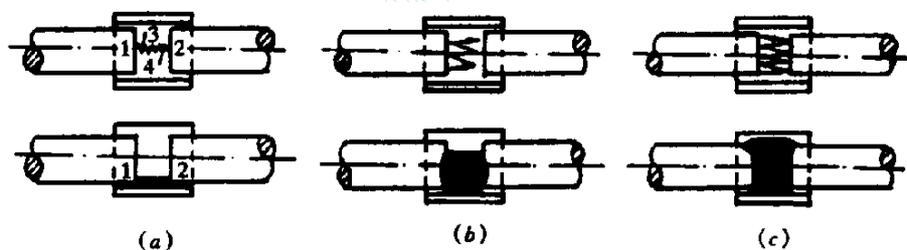
图 9 窄间隙焊工艺过程示意图
