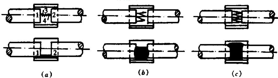
图9 窄间隙焊工艺过程示意图
