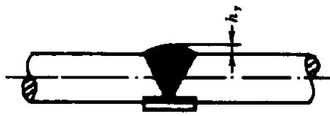
图 2 焊缝余高
