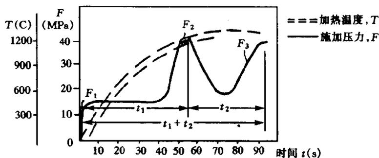
图 12 三次加压法焊接工艺过程图解
