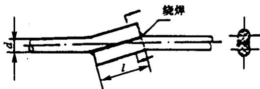
图 8 钢筋搭接焊
