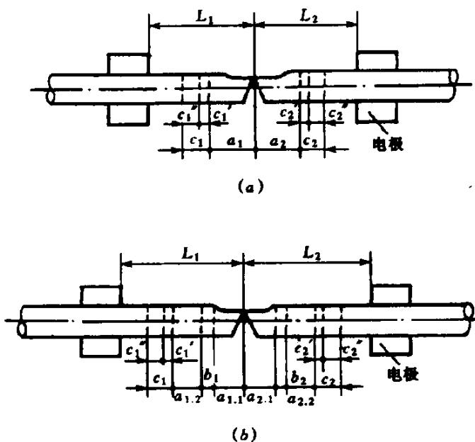
图 7 钢筋闪光对焊留量图解
