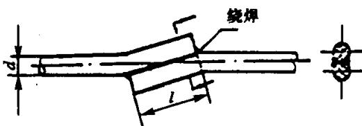
图 8 钢筋搭接焊
