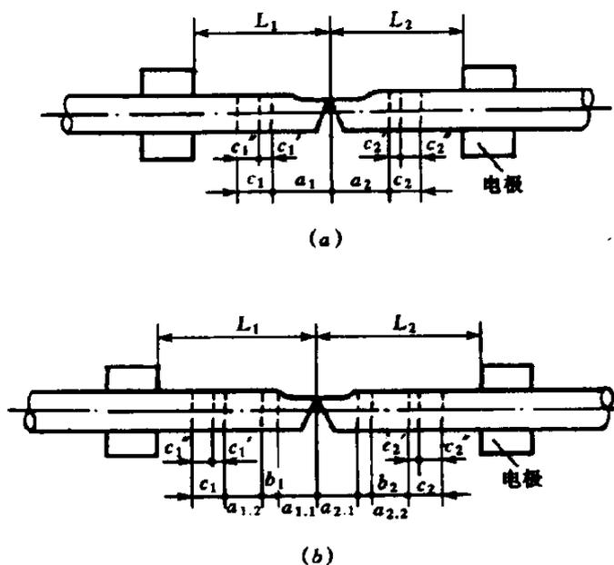
图 7 钢筋闪光对焊留量图解
