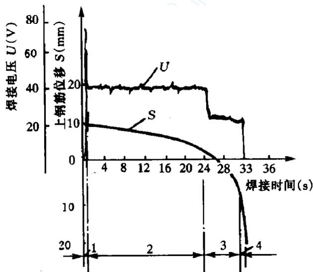
图 11 钢筋电渣压力焊工艺过程图解
