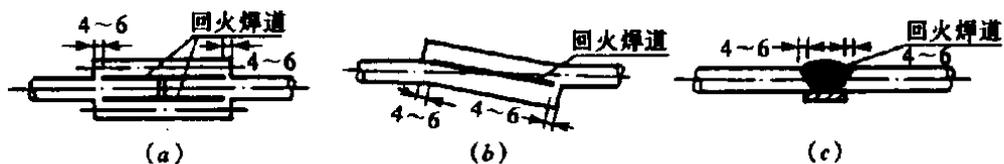
图4 钢筋负温电弧焊回火焊道示意图
