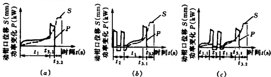
图 6 钢筋闪光对焊工艺过程图解
