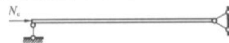
图 5.2.7 连墙件计算简图
