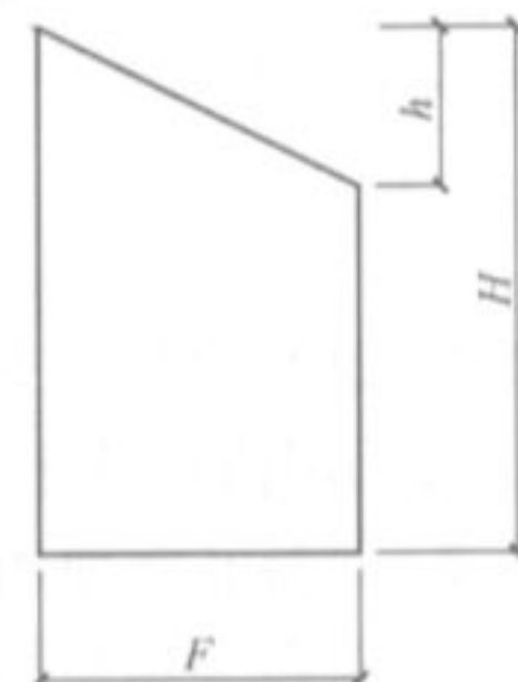
图 4.1.1 混凝土侧压力计算分布图形
