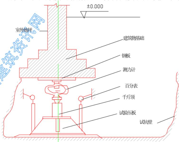
图 A.0.3 载荷试验示意
