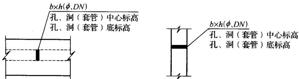
图 3.3.4 预留孔、洞及预埋套管的表示方法
