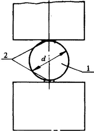
图 D.0.4-1 劈裂抗拉试验
