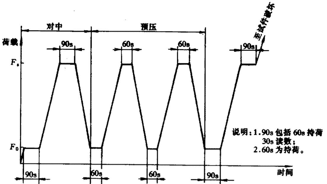
图 8.0.4 弹性模量加荷方法示意图
