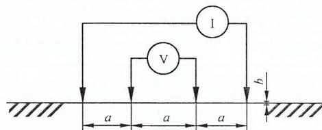
图 D.1 电极均匀布置
