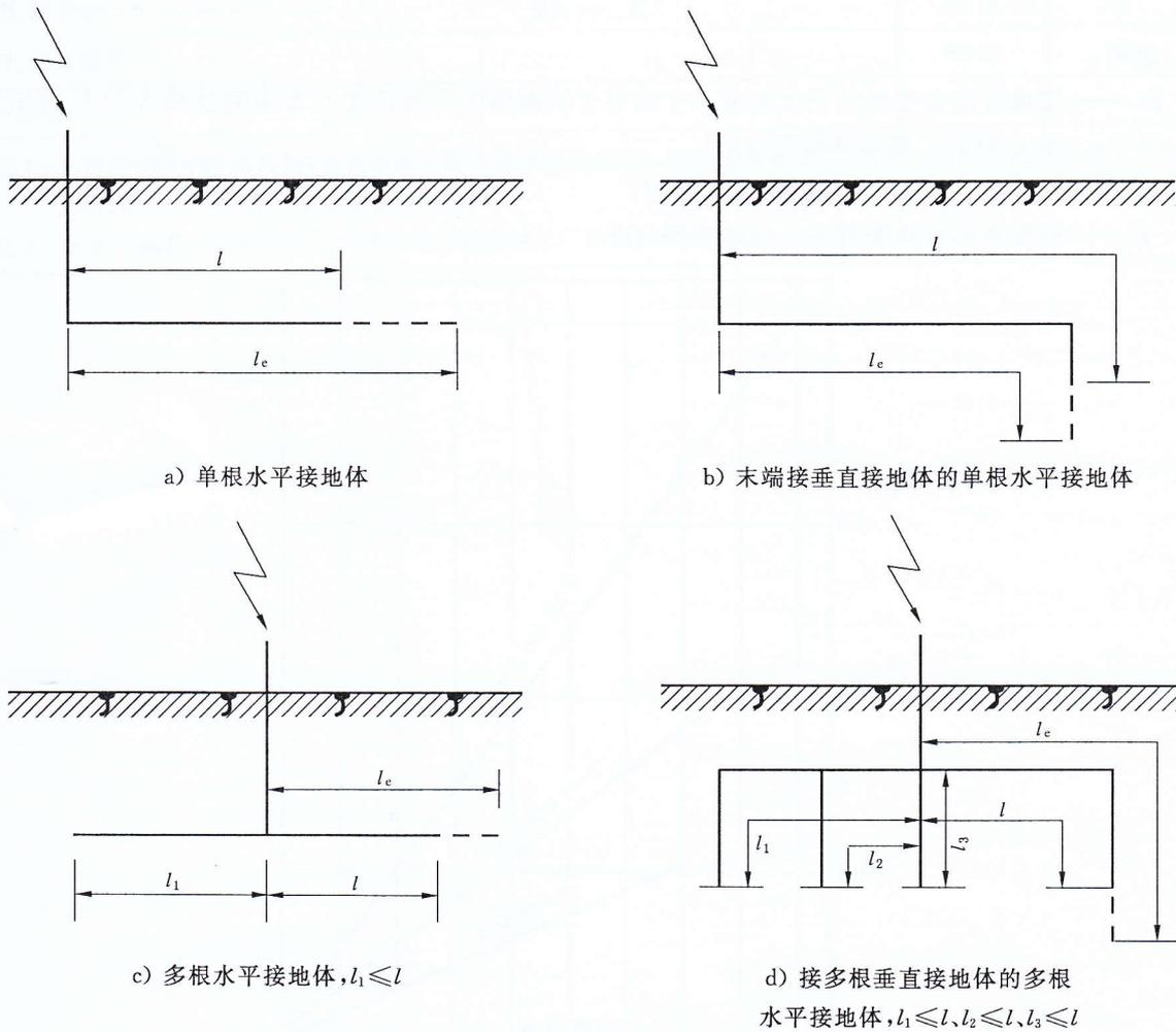
图 B.2 接地体有效长度的计量
