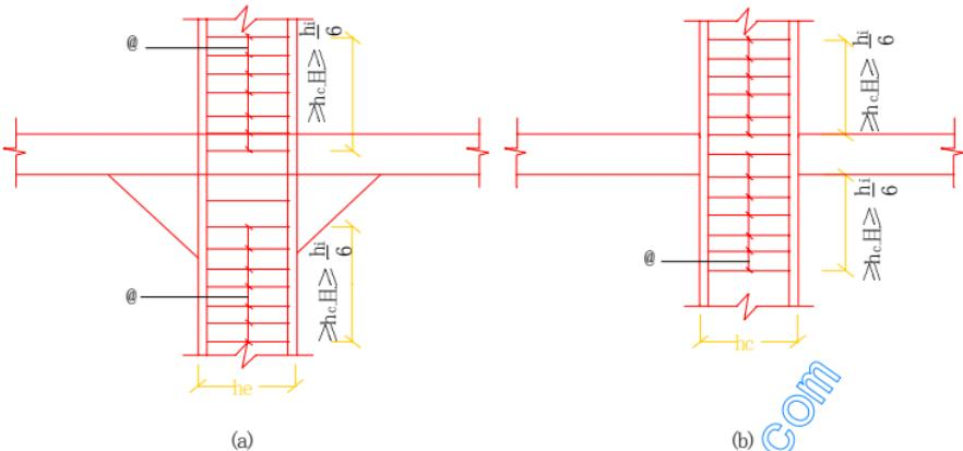
图 6·3·2 板柱节点抗震构造
