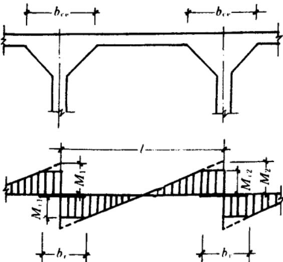
图 3·3·8 有柱帽等代框架梁在水平荷载作用下支座弯矩取值
