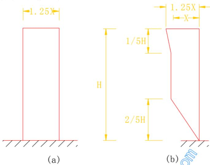
附图 8·3 连杆内力  $X$  产生并经修正的剪力
