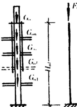
图 4·2·3—1 搁置状态时柱的计算简图
