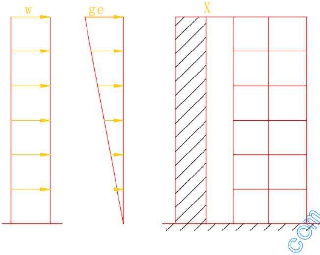
附图 8·2 板柱——剪力墙结构单连杆计算简图
