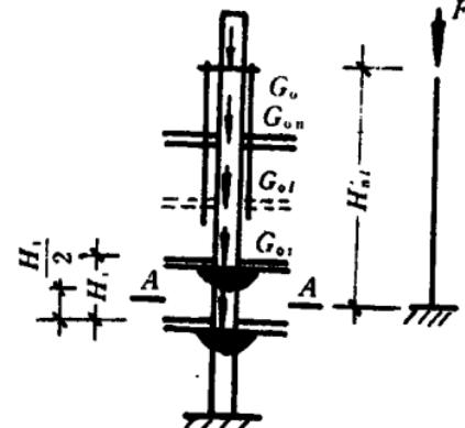
图 4·2·3-4 一层或数层节点刚接后正在提升状态时柱的计算简图
