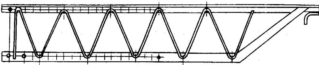
图 A.0.3-5 平面可调桁架
