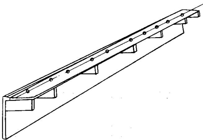
图 A.0.1-7 搭接模板
