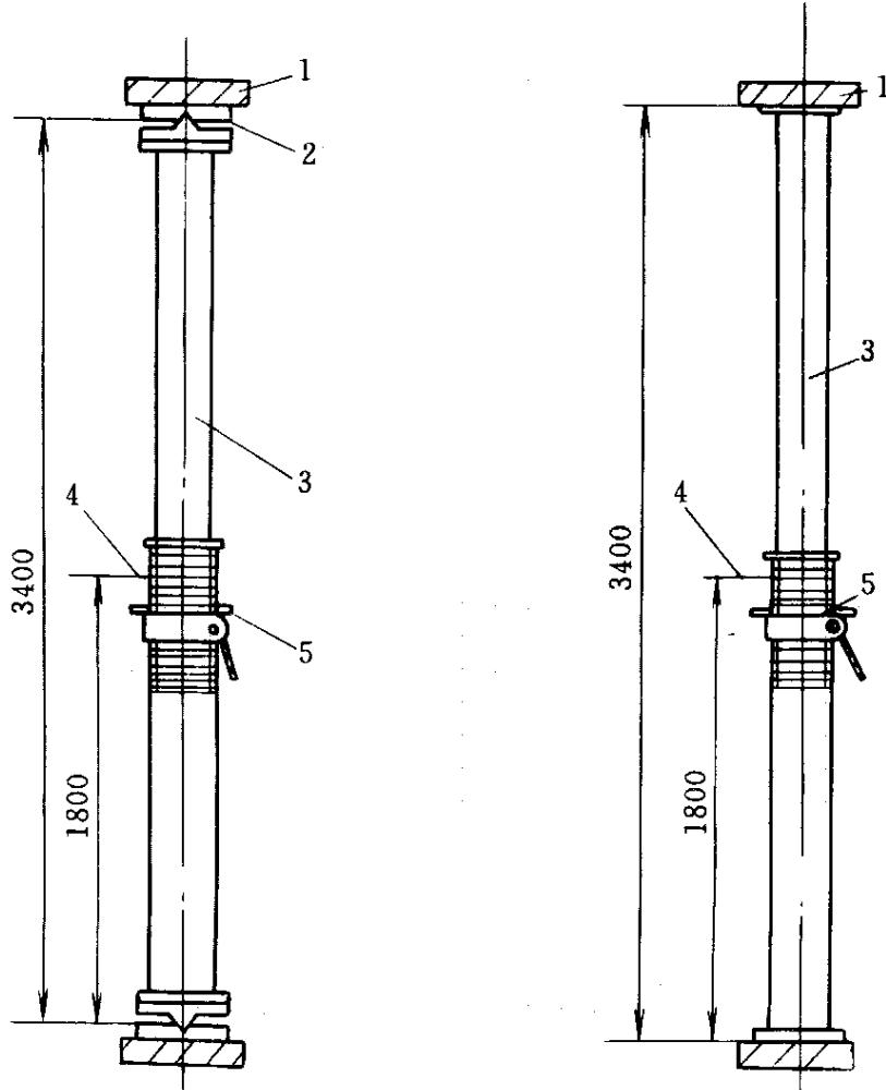
图 H.0.1-1 刀形支承试验
