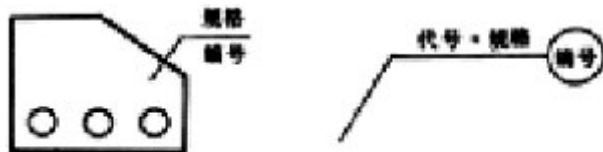
图 4.4.8 构件编号的标注
