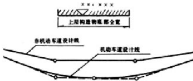
图 3.4.5 立交工程上层构造物的标注
