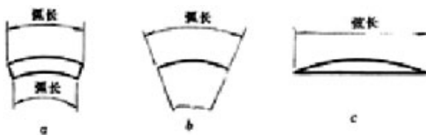
图 2.7.9 弧、弦的尺寸标注
