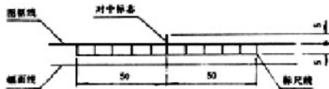
图 2.1.2 对中标志及标尺(单位:mm)
