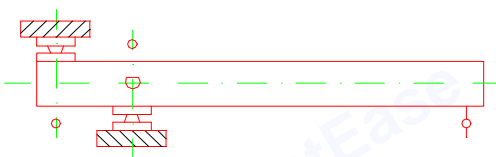
图 6.1.2-6 具有固端联结的悬臂式结构整体变形量测的测点布置 ○—挠度计；⊗—倾角仪
