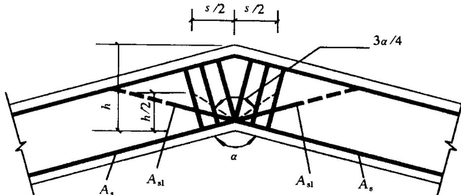
图 10.2.14 钢筋混凝土梁内折角处配筋
