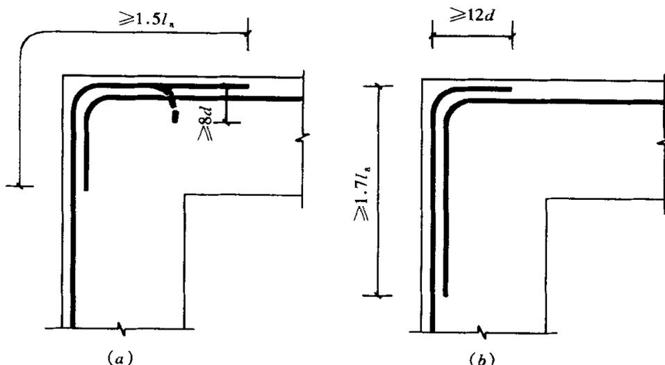
图 10.4.4 梁上部纵向钢筋与柱外侧纵向钢筋在顶层端节点的搭接
