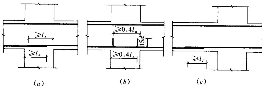
图 10.4.2 梁下部纵向钢筋在中间节点或中间支座范围的锚固与搭接
