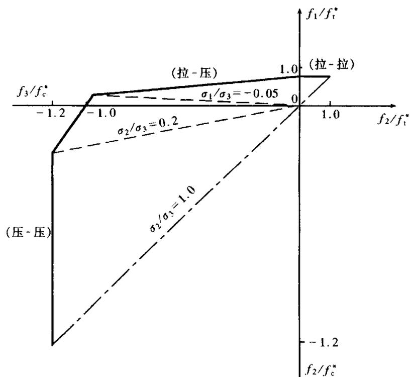
图 C.3.2 混凝土的二轴强度包络图
