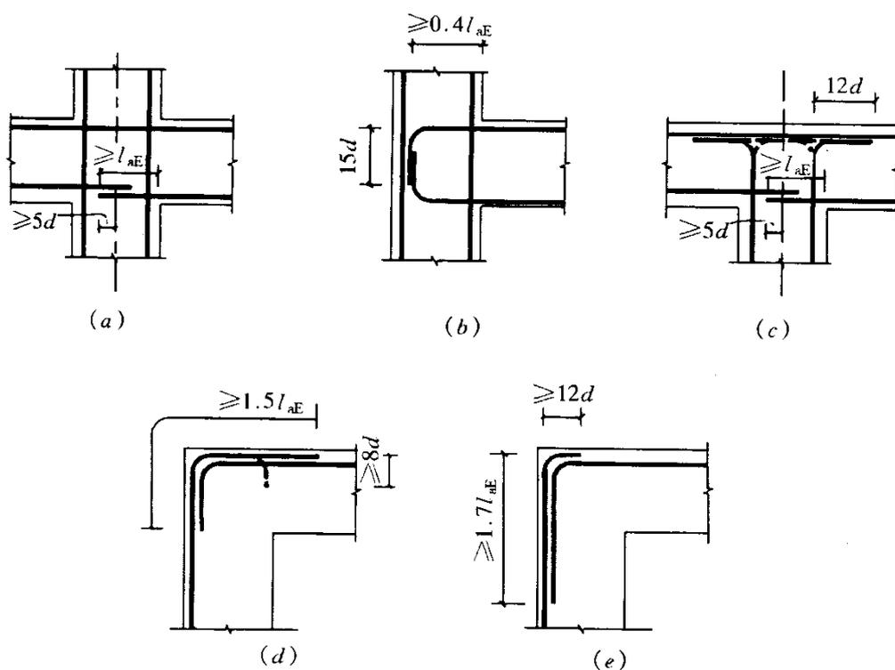
图 11.6.7 框架梁和框架柱的纵向受力
