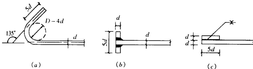
图 9.3.2 钢筋机械锚固的形式及构造要求
