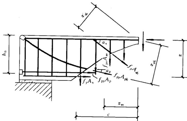
图 7.5.9 受弯构件斜截面受弯承载力计算
