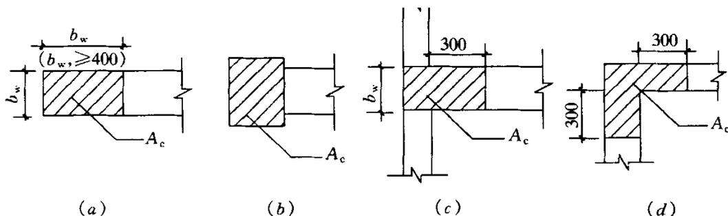
图 11.7.16 剪力墙的构造边缘构件
