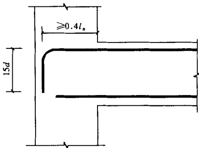
图 10.4.1 梁上部纵向钢筋
