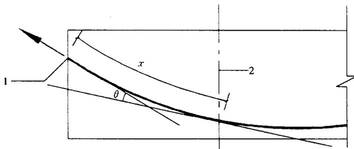
图 6.2.4 预应力摩擦损失计算
