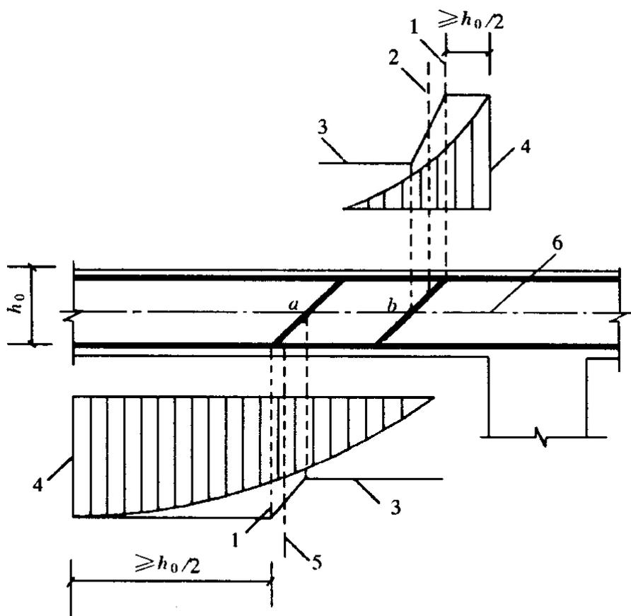
图 10.2.8 弯起钢筋弯起点与弯矩图的关系
