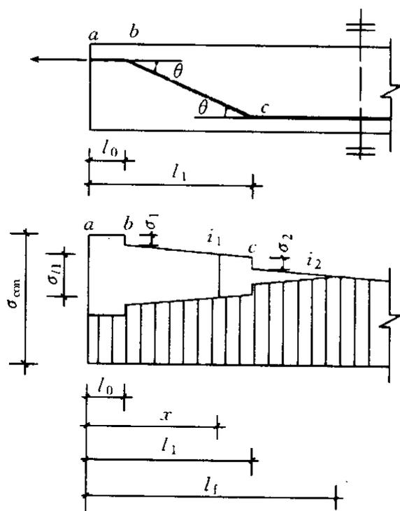
图 D.0.3 折线形预应力钢筋的
