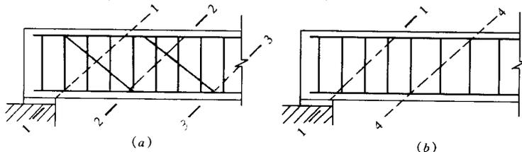
图7.5.2 斜截面受剪承载力剪力设计值的计算截面
