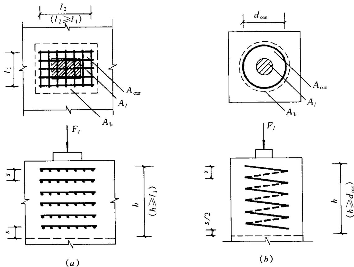
图 7.8.3 局部受压区的间接钢筋
