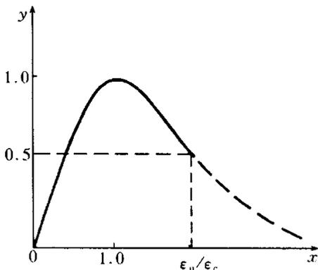
图 C.2.1 单轴受压的应力-应变曲线
