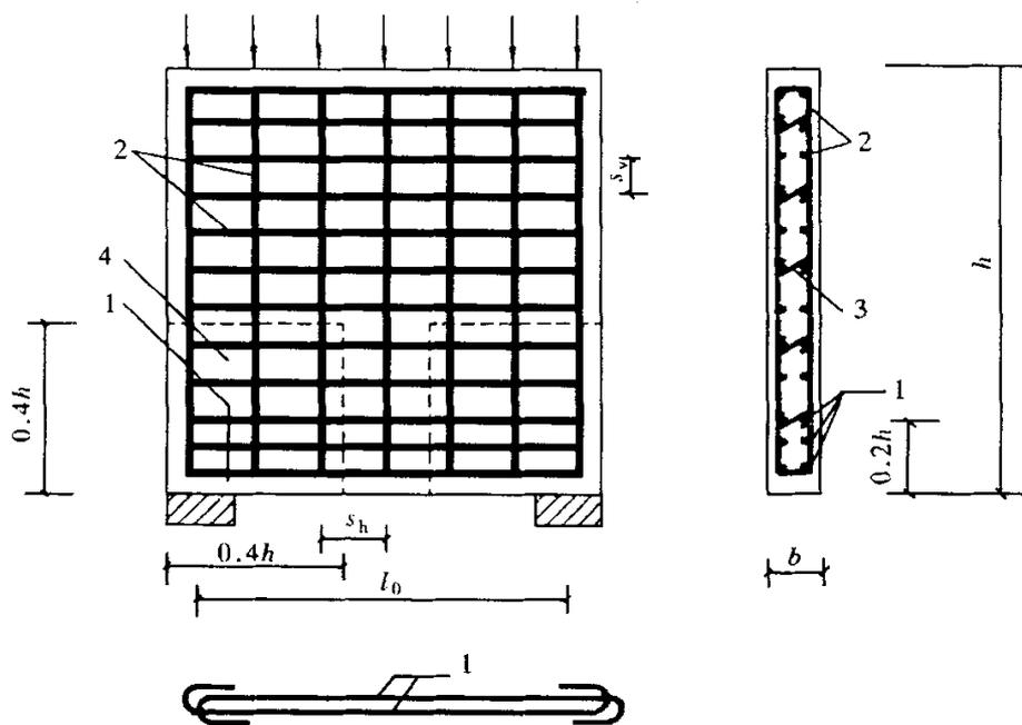
图 10.7.9-1 单跨深梁的钢筋配置
