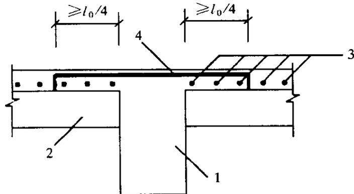
图 10.1.6 现浇板中与梁垂直的构造钢筋
