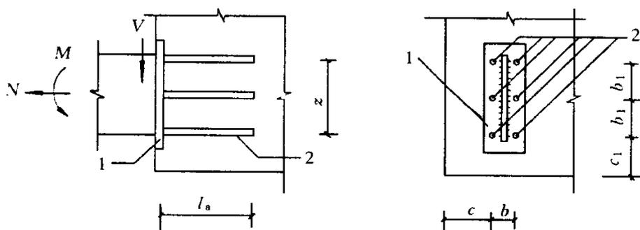
图 10.9.1 由锚板和直锚筋组成的预埋件
