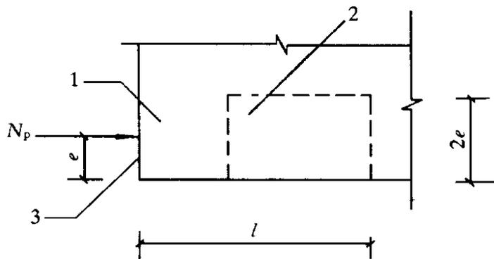
图 9.6.9 防止沿孔道劈裂的配筋范围
