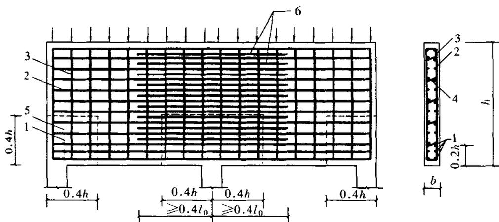
图 10.7.9-2 连续深梁的钢筋配置
