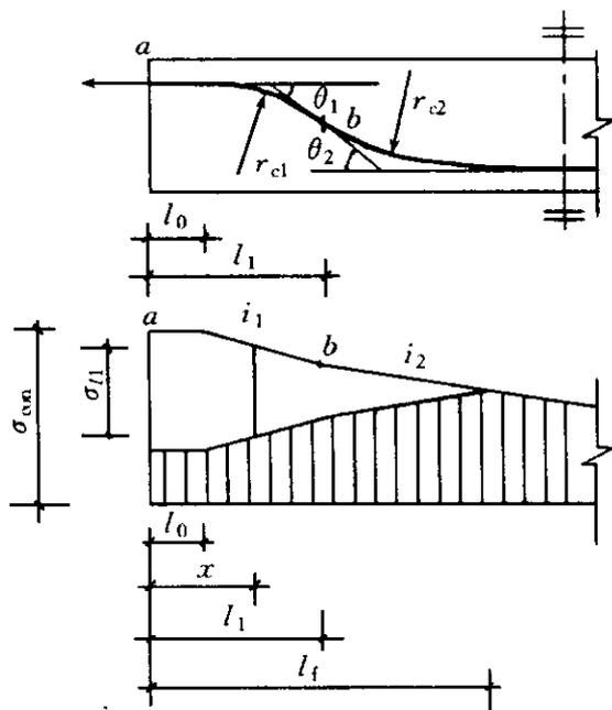
图 D.0.2 两条圆弧形曲线组成的预应力钢筋的预应力损失  $\sigma_{11}$
