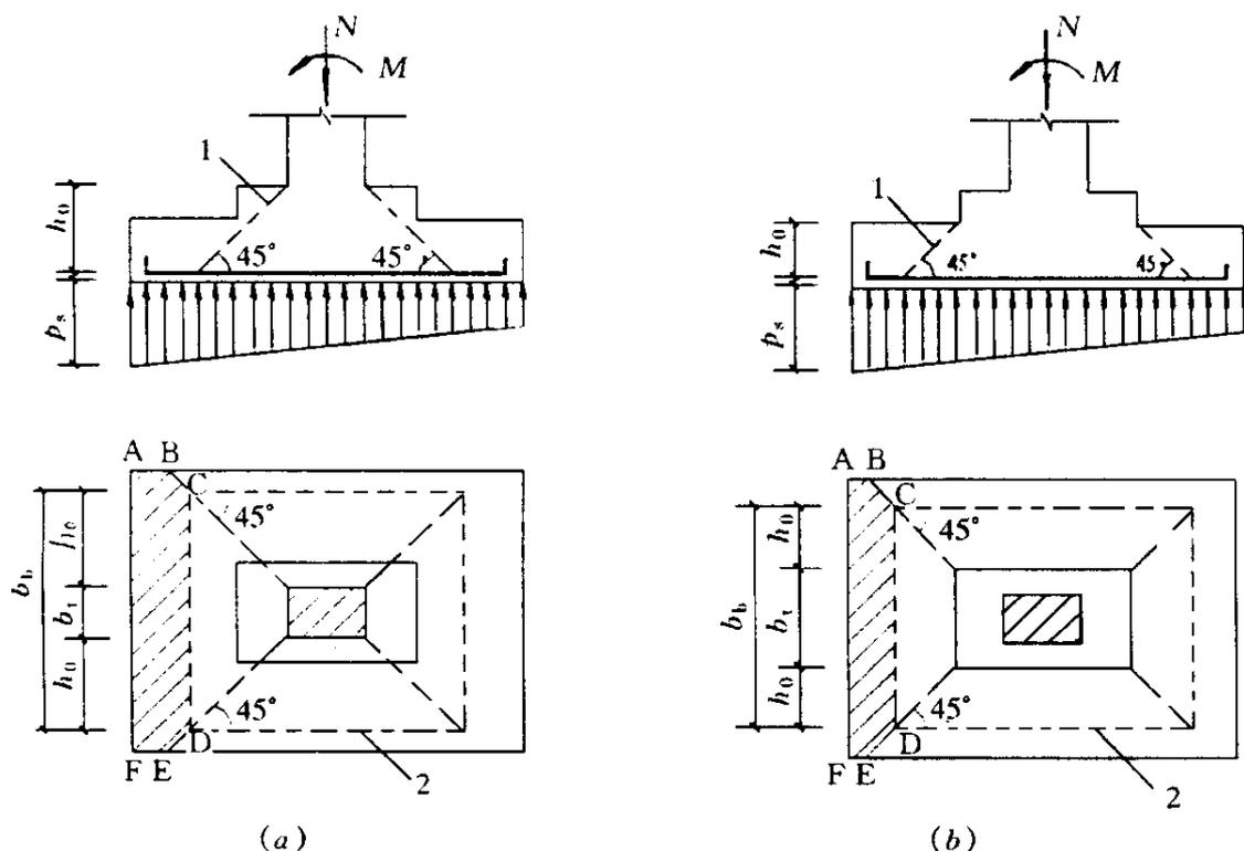
图 7.7.4 计算阶形基础的受冲切承载力截面位置
