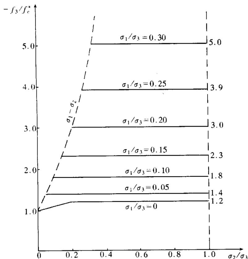
图 C.3.3 混凝土的三轴抗压强度
