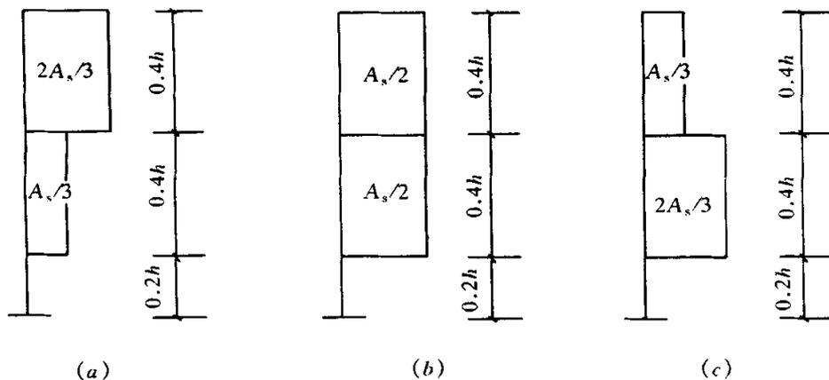
图 10.7.9-3 连续深梁中间支座截面纵向受拉钢筋在不同高度范围内的分配比例
