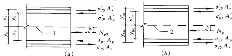
图 6.1.6 预应力钢筋及非预应力钢筋合力位置
