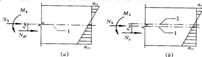
图 6.1.11 预应力混凝土构件施工阶段验算
