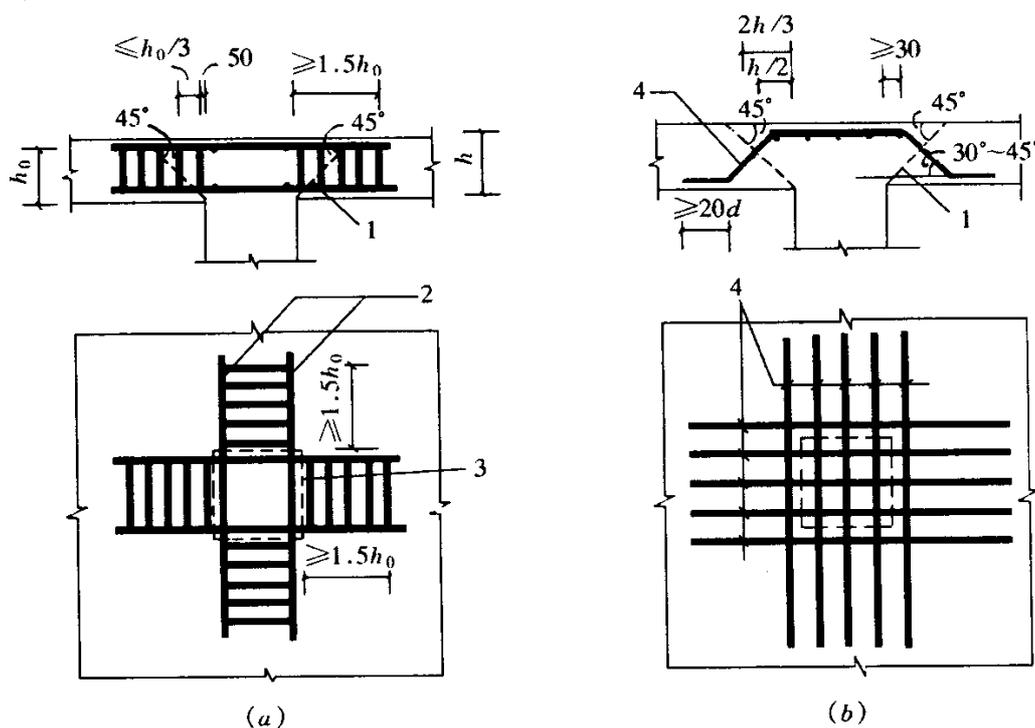
图 10.1.10 板中抗冲切钢筋布置
