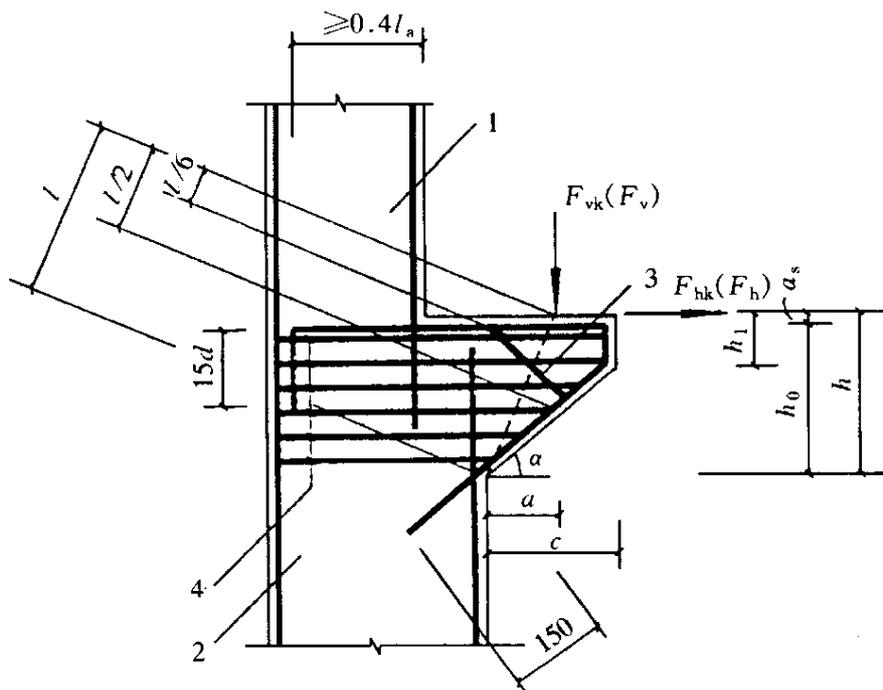
图 10.8.1 牛腿的外形及钢筋配置
