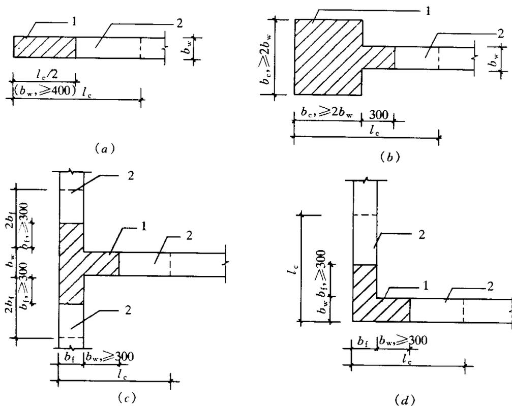
图 11.7.15 剪力墙的约束边缘构件
