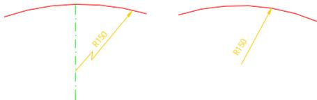
图 10.4.3 大圆弧半径的标注方法
