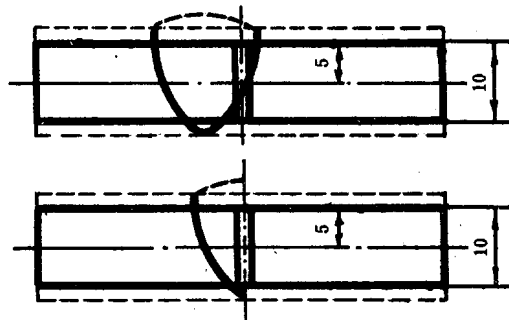
图 4 开在熔合线的缺口位置
