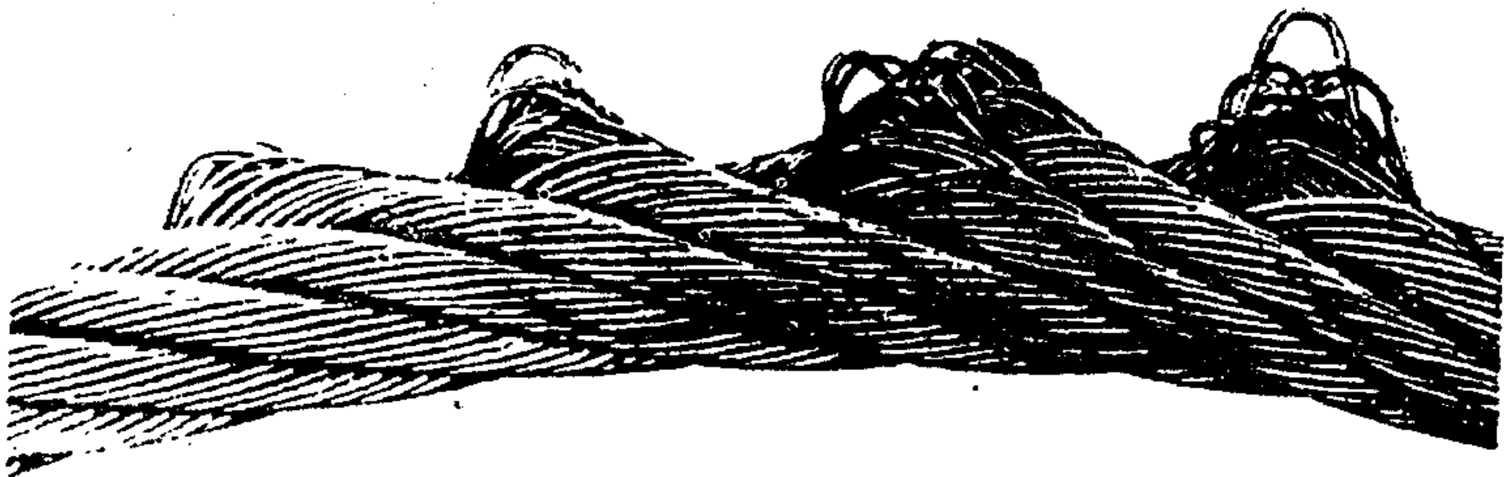
图 E. 12 上述缺陷严重恶化——应立即报废(打桩机用起重钢丝绳是一典型)
