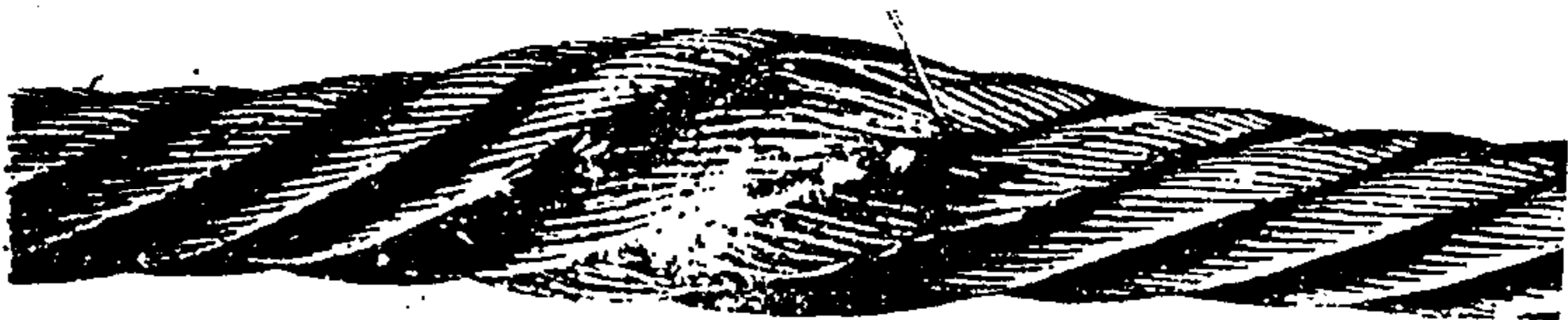
图 E. 18 部分被压扁：是由于局部被压裂造成绳股间不平衡加之断丝而引起的——应报废
