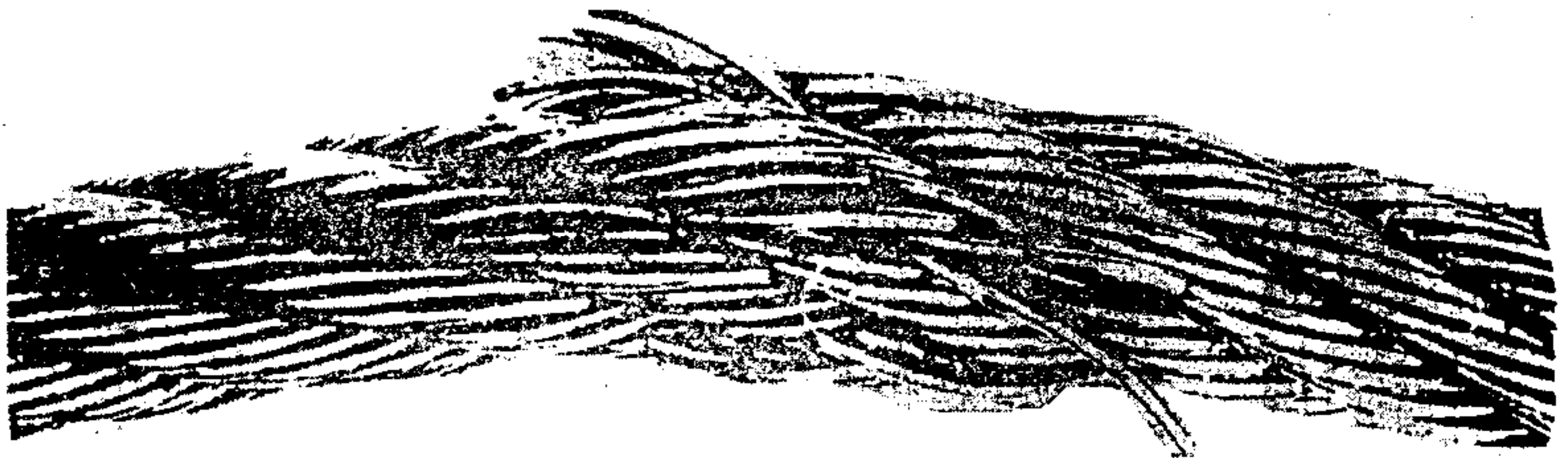
图 E.5 靠近平衡滑轮局部绳段,若干绳股有断丝(有时断丝被滑轮挡住)——应报废
