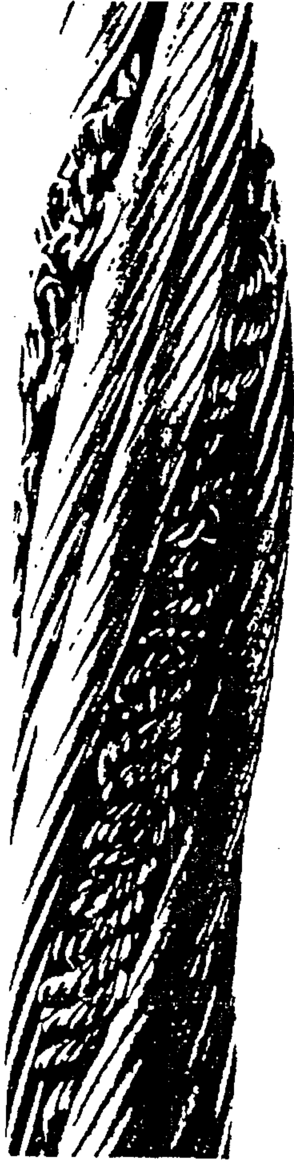
图 E. 13 同向捻钢丝绳直径的局部增大:常由冲击载荷导致的钢芯畸变而引起——应立即报废
