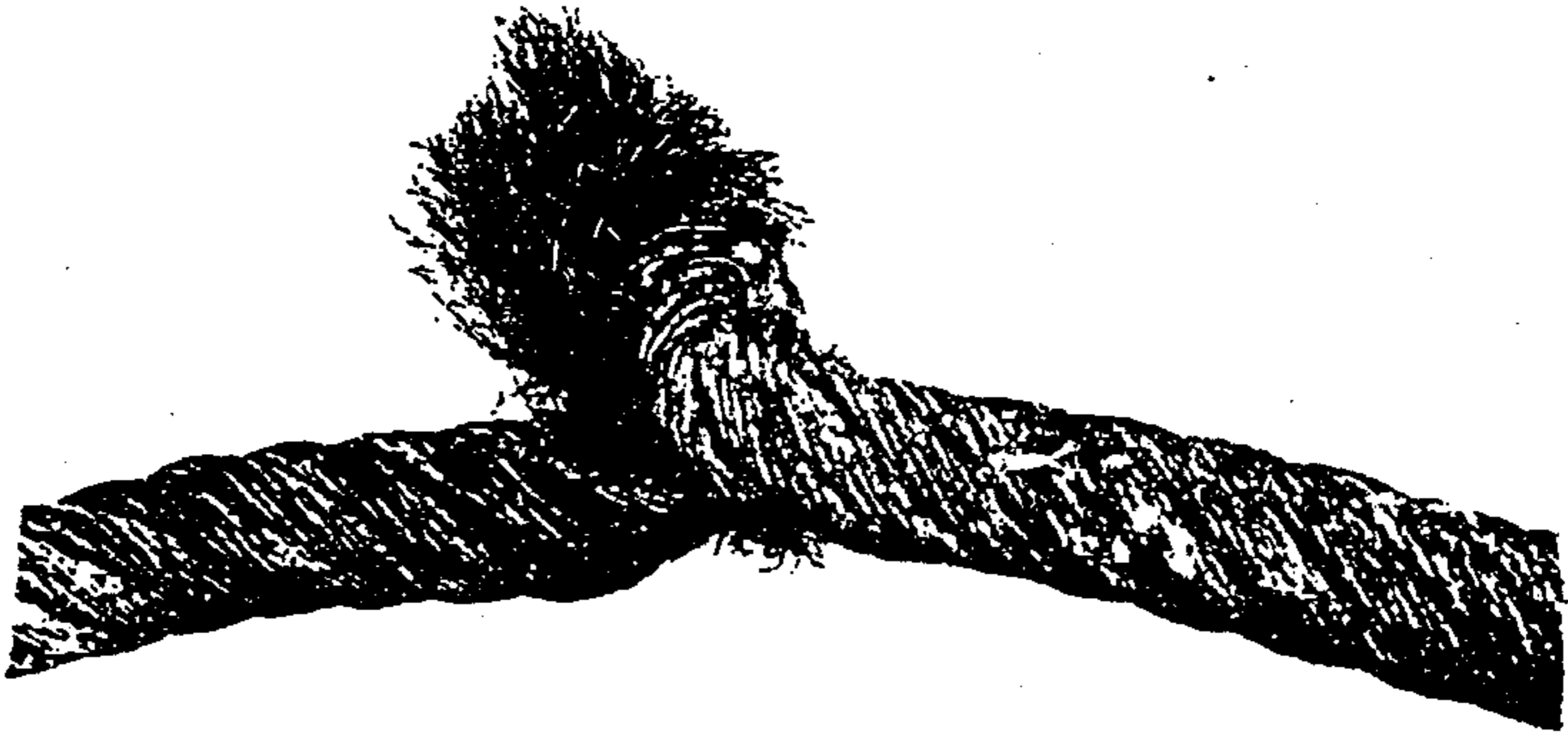
图 E. 15 严重扭结：钢丝绳搓捻过紧而引起纤维芯的突出——应立即报废
