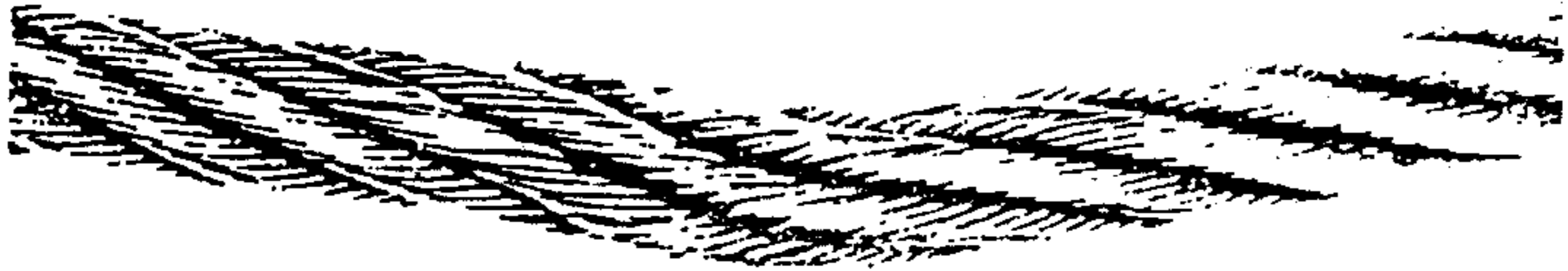
图 E. 16 钢丝绳在安装时已遭到扭结但仍装上使用，以致产生局部磨损及钢丝松弛——应报废
