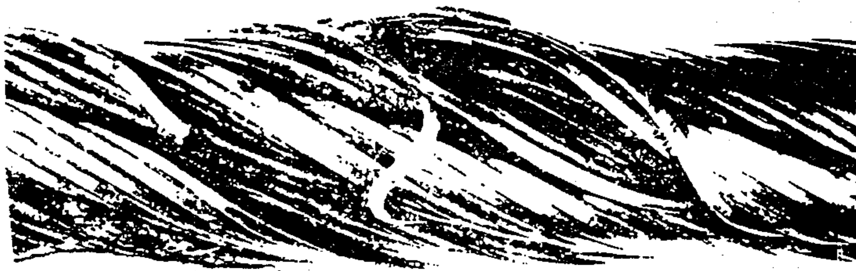
图 E.22 若干种损坏因素累积的后果：特别注意外层钢丝的严重磨损导致钢丝的松弛，以致笼状畸变正在形成，并有若干处断丝——应立即报废
