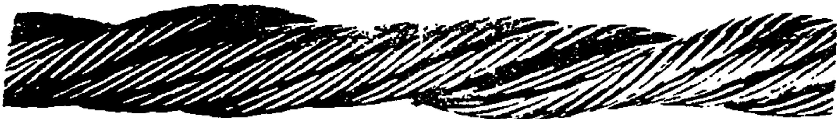
图 E. 17 绳径局部减小：由于外层绳股取代了已经散开的纤维绳芯而引起， 注意尚有断丝——应立即报废
