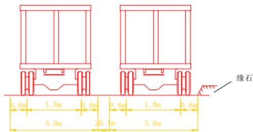
图 4.1.3-3 车辆荷载横桥向布置
