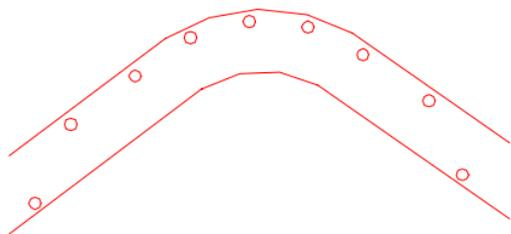
图 4-2-3-1 曲线路段上的灯具设置
