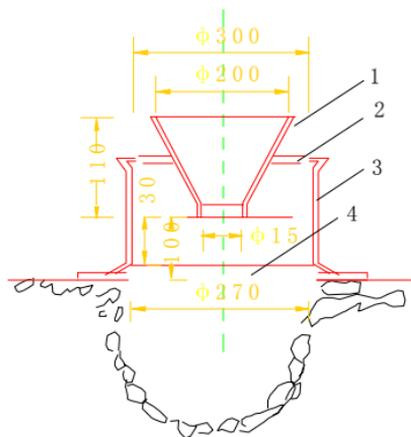
附图 5.2 灌砂法密度试验仪
