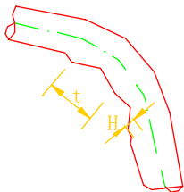
图 6-2-4-1 弯曲部分波浪度
