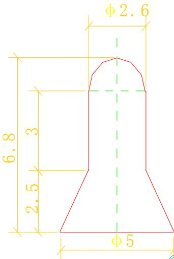
图 3.0.5—2 不锈钢测头 尺寸单位:mm
