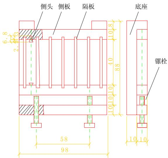
图 3.0.5—1 金属试模 尺寸单位:mm
