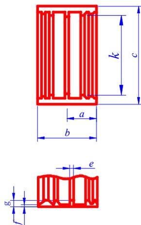
图 D. 0. 2 钢带型卡箍橡胶密封套
