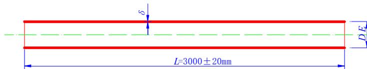
图 A. 0. 2 平口铸铁管尺寸
