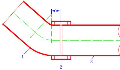
图 B. 0. 2 卡箍式连接安装
