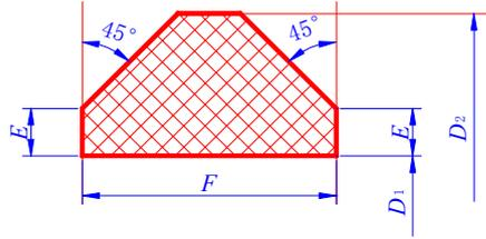
图 D. 0.1 橡胶密封圈截面
