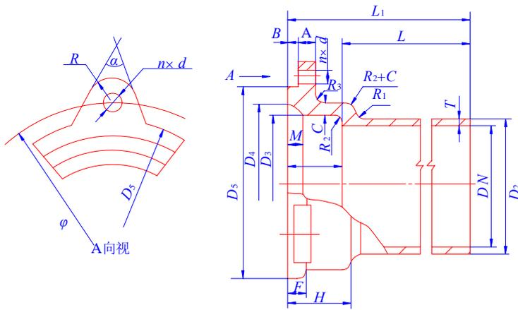
图 A.0.1 承插式管材尺寸
