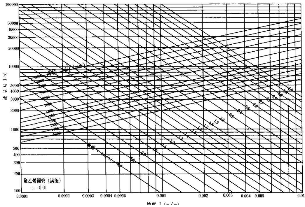
图 A.0.2 满流条件下聚乙烯管管道水力计算图 (内径 1300~3000)
