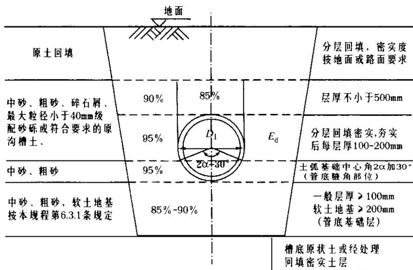
图 8.2.5 沟槽回填土要求
