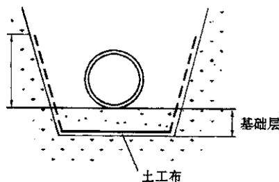
图 E8.2.6-3 防细颗粒土流失的土工布包裹方法
