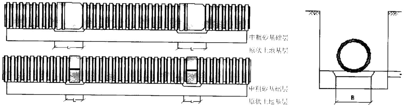
图 6.3.3 管道接口处的凹槽
