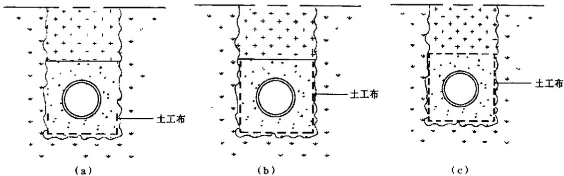
图 E8.2.6-1 软土地层中管道的土工布加固方法
