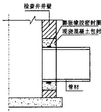
图 7.0.2 现浇混凝土包封连接
