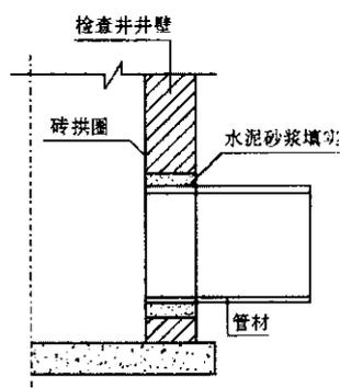
图 7.0.3 管道与检查井预留洞的连接
