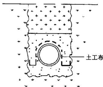
图 E8.2.6-2 防管道上浮的土工布包裹方法
