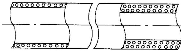
(c) 缠绕圆形中空肋壁管A型
