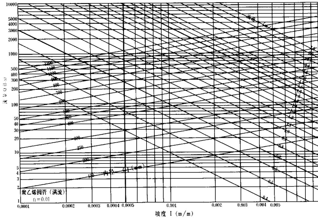
图 A.0.1 满流条件下聚乙烯管管道水力计算图 (内径 150~1200)
