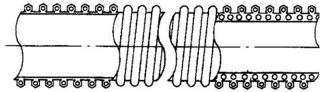
(d) 缠绕圆形中空肋壁管B型
