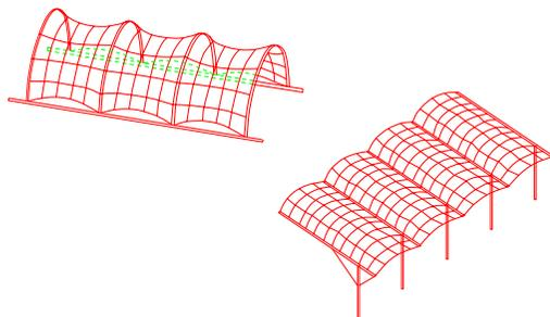
图 3.1.3 骨架支承式膜结构
