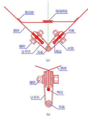
图 6.3.2-3 膜材与谷索的连接
