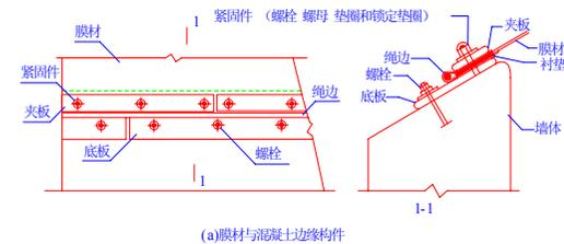
(a)膜材与混凝土边缘构件
