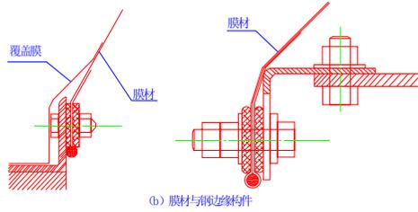
图 6.3.3 膜材与边缘构件的连接
