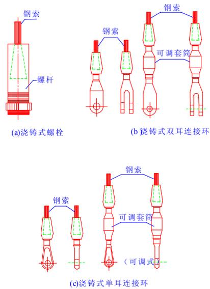
图 6.4.3-1 浇铸式索端连接件
