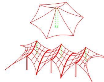
图 3.1.2 整体张拉式膜结构
