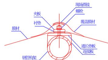
图 6.3.1 膜材与支承骨架的连接
