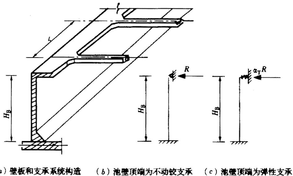
图 6.1.4 走道板、工作平台作为池壁的支承构件
