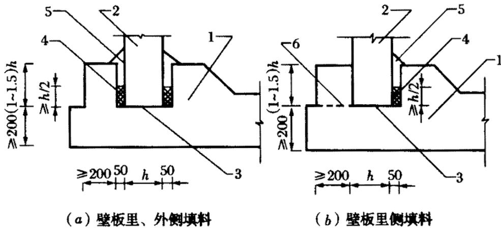
图 7.2.12 壁板与底板的杯槽连接
