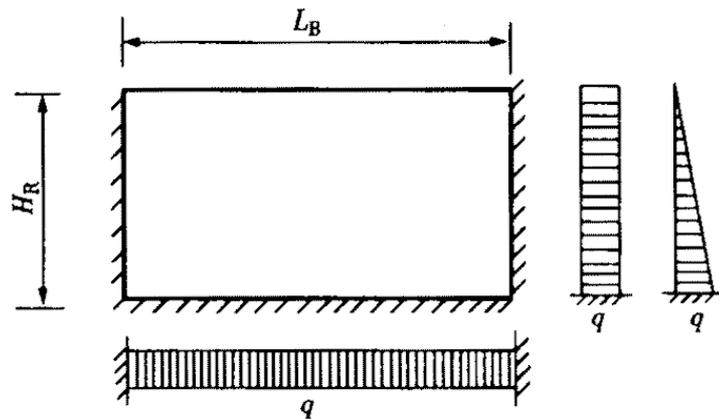
图 6.1.6 三边固定、顶端自由双向板的侧向荷载
