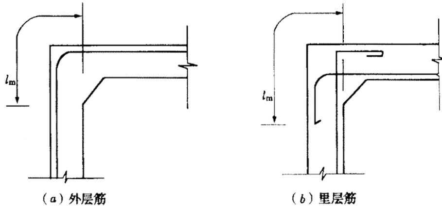
图 7.1.11 池壁拐角处钢筋的锚
