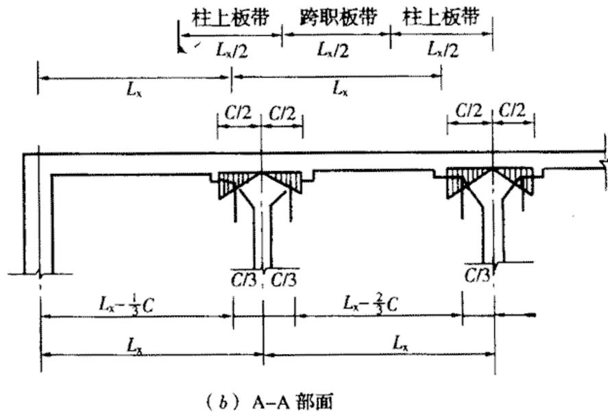
图 6.1.8 无梁板结构按等代框架计算
