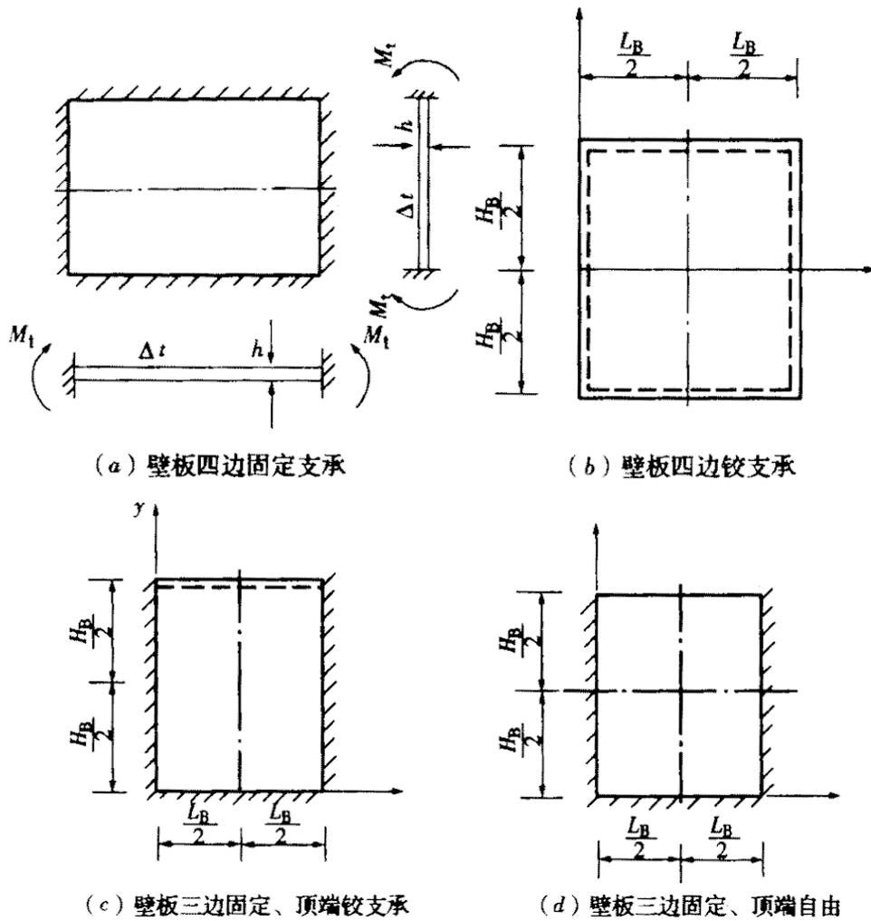
图 6.1.10 双向受力壁板在壁面温差或湿度当量温差作用下的内力计算简图
