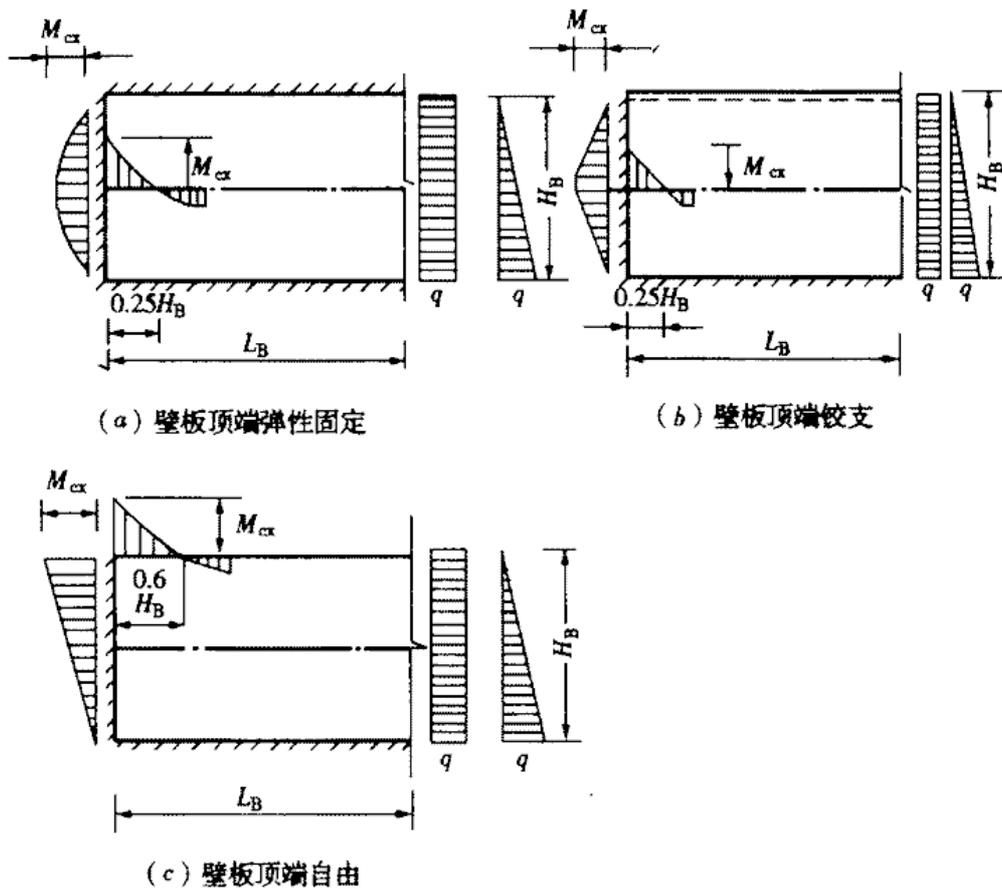
图 6.1.3 壁板水平向角隅处的局部负弯矩
