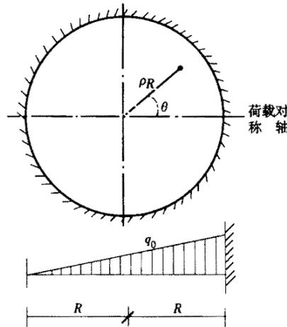
图 6.2.6 周边固定支承的圆板承受三角形荷载的计算
