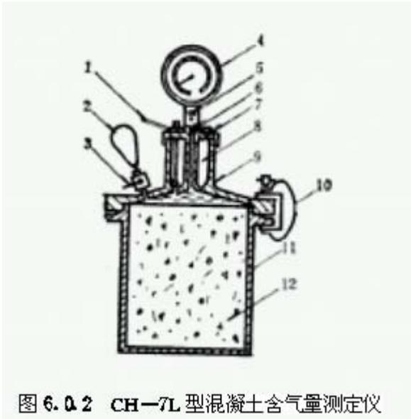
图 6.0.2 CH—7L 型混凝土含气量测定仪
