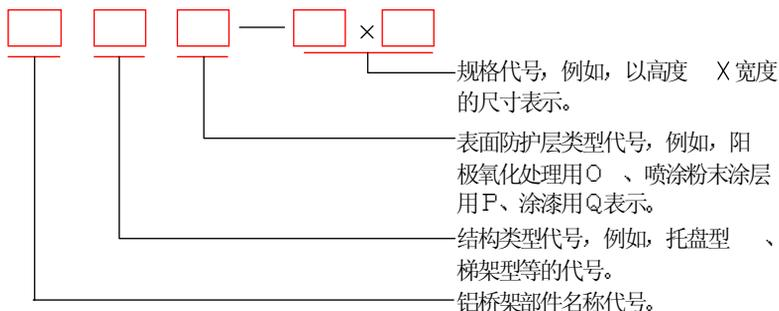
**3.1.2** 铝桥架的常用规格尺寸系列应符合表 3.1.2 的规定；
