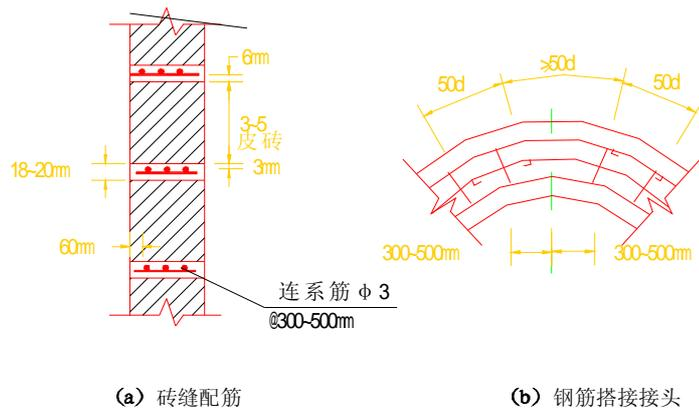
图 5.2.3 配筋砌体构造示意图
