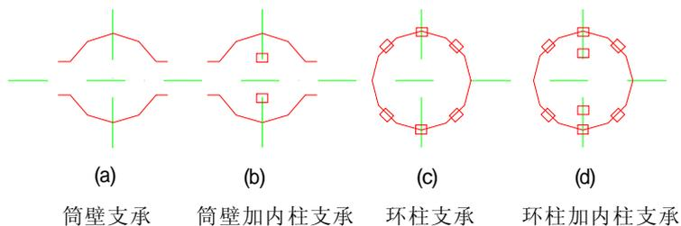
图 2.2.5 仓下支承结构型式图
