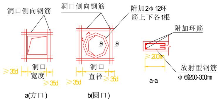
图 5.3.6 填料平板洞口四侧钢筋示意图
