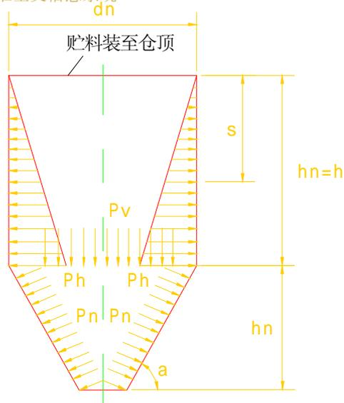
图 3.2.3 浅仓压力示意图
