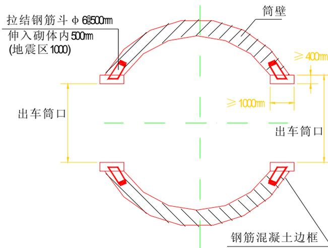
图 5.4.3 出车洞口边框构造示意图
