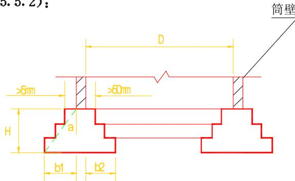
图 5.5.2 环形刚性基础图
