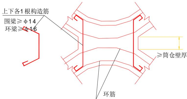
图 5.2.7 筒仓壁连接构造图
