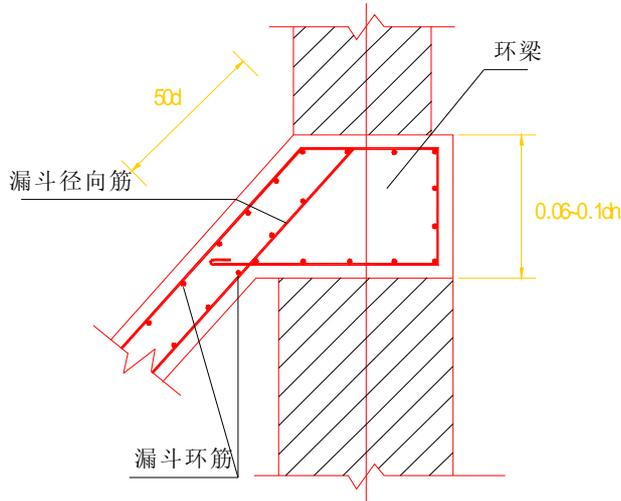
图 5.4.5 环梁及配筋示意图
