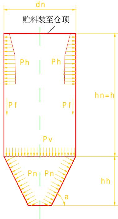
图 3.2.2 深仓压力示意图
