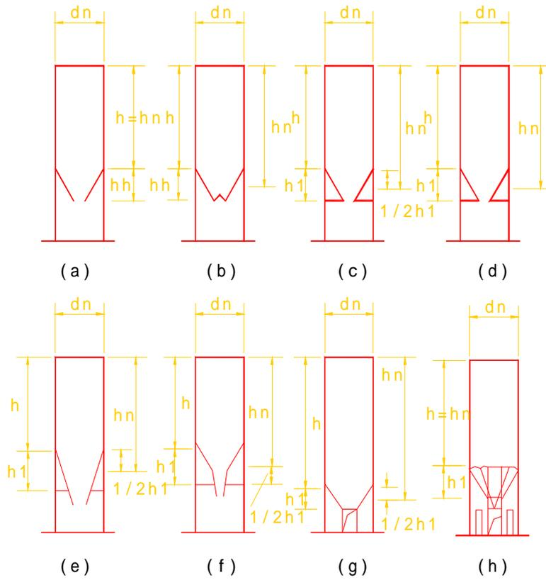
(a)漏斗单口 (b)漏斗双口 (c)梁、板填料单口
