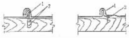
图 4-12-31 钢板带固定薄钢板方法 1-钢板带 2-钉子
