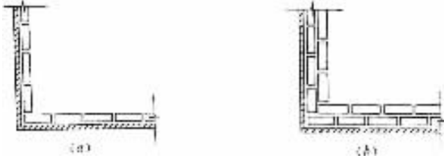
图 4-15-2 防腐块材阴阳角铺砌方法
