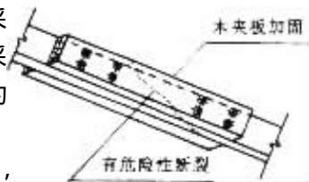
图 4-16-9 屋架上弦个别节间出现断裂迹象的加固
