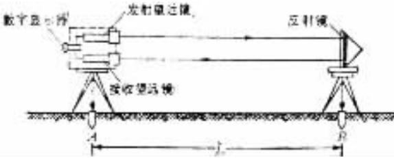
图 3-6-57 光电测距仪使用示意
