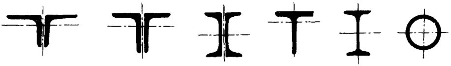
图 3-4-3 普通桁架拉弯和压弯杆件的截面型式
