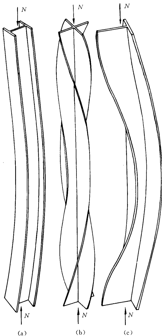
图 3-2-6 轴心受压构件的屈曲形态（两端铰接）
