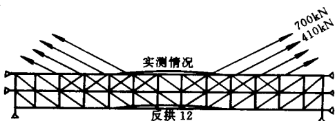
图 7-4-96 斜拉索拉力作用下立体桁架受力情况
