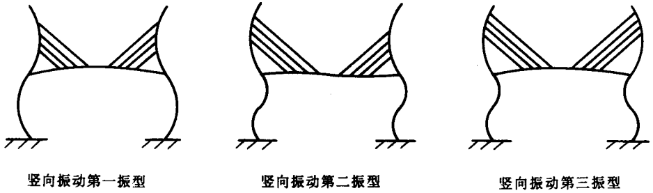
图 7-4-97 中间桁架的竖向振动振型
