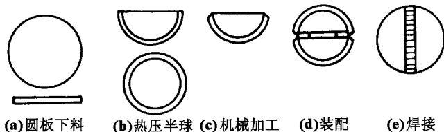
图 6-5-2 焊接钢球制作法
