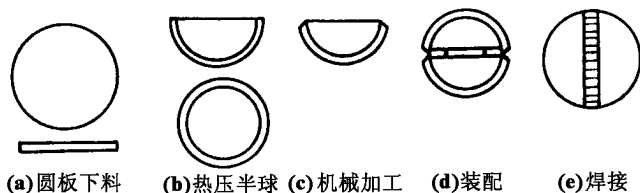
图 6-5-2 焊接钢球制作法
