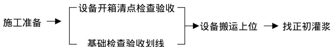
→ 清洗调整 → 无负荷试车 → 投运联动试车 → 交出验收
