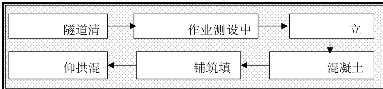
图 9-8 仰拱填充施工顺序图
