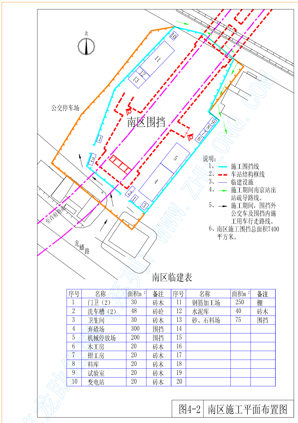
图 4-2 南区施工平面布置图
