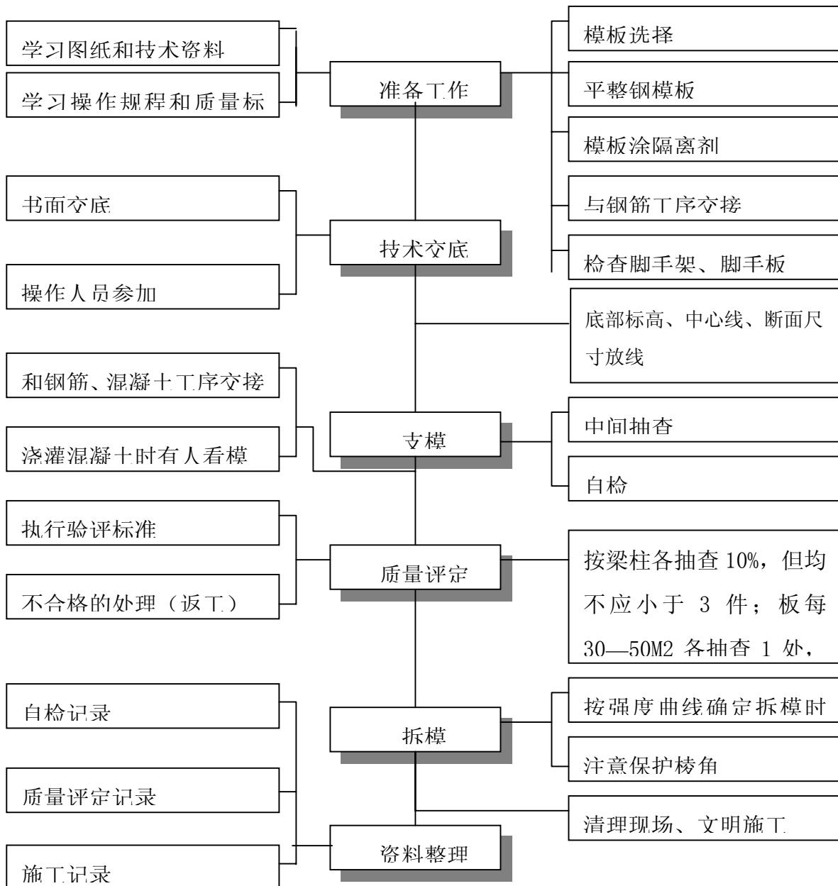
图 6-5 模板工程质量程序控制表
