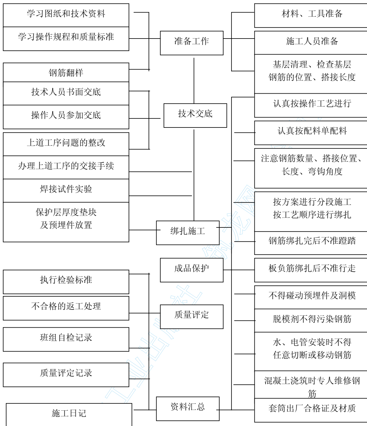
图 8-16 钢筋绑扎施工工程质量控制程序
