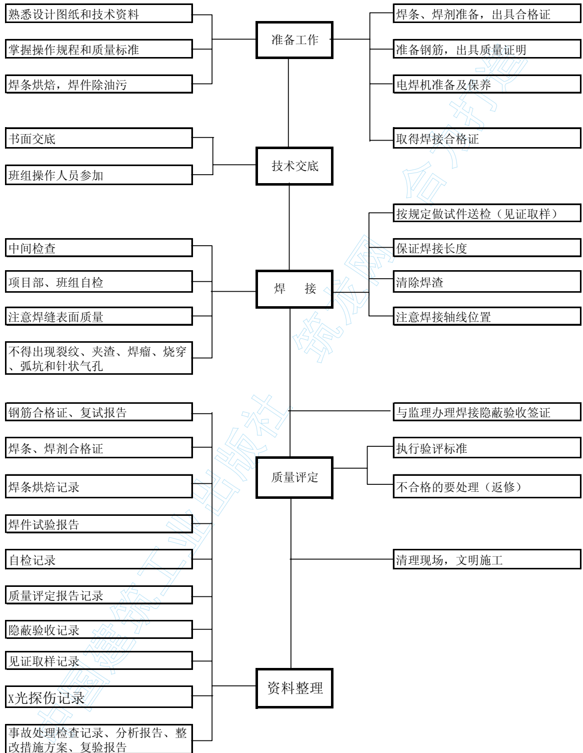
附表4 钢筋焊接工程质量控制程序
