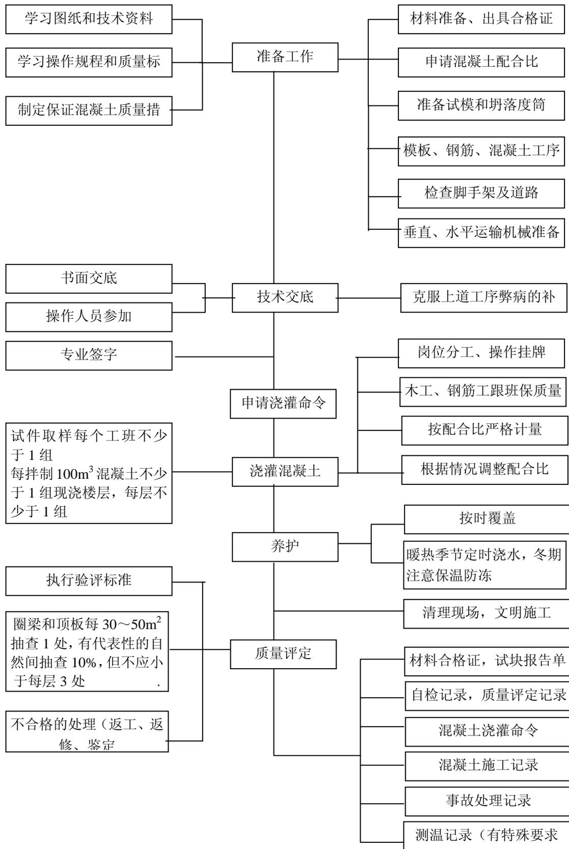
图 8-5 混凝土工程质量预控程序
