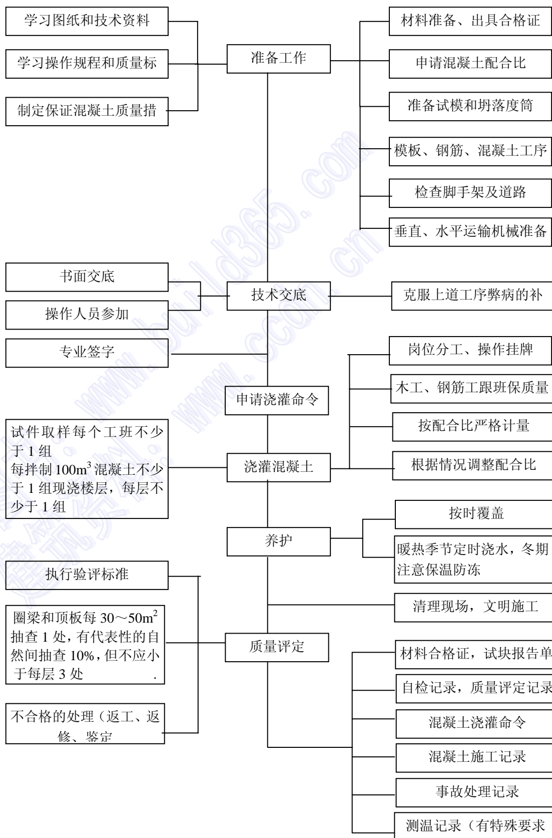
图 8-5 混凝土工程质量预控程序
